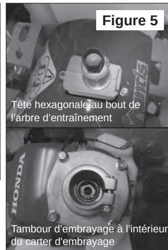
Le moteur est engagé jusqu'au fond sur le réducteur.
