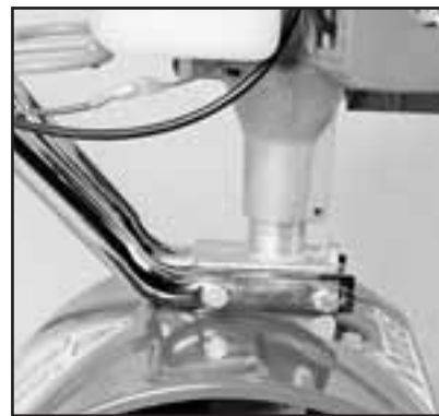
Ilustración 1 Nótese cómo el motor no está apoyado totalmente sobre la transmisión helicoidal.
